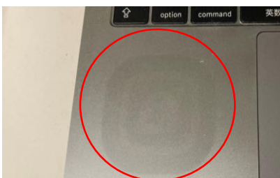
ステッカー跡による変色
