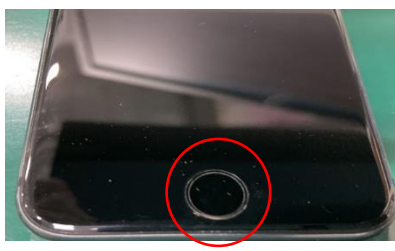
ホームボタン不良
